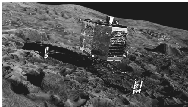
Abbildung 5. Computergraphik des Rosetta-Landegeräts Philae auf der Oberfläche des Kerns des Kometen 67P/Churyumov-Gerasimenko. Philae ist mit einem enantioselektiven GC-MS ausgestattet, das drei chirale stationäre Phasen enthält. Abbildung: ESA.
